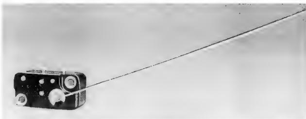
Bild 5. Dieser einpolige und sehr leicht ansprechende Drehumschalter mit Fühlhebel in Kleinformat für eine Wechselspannung bis 250 V kann bis zu 5 A belastet werden (Harting)
