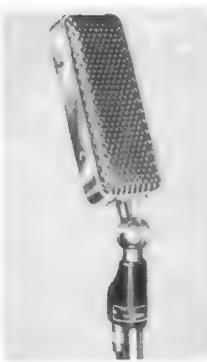
Bild 11. Kristallmikrofon MSK 5 von Schumann
